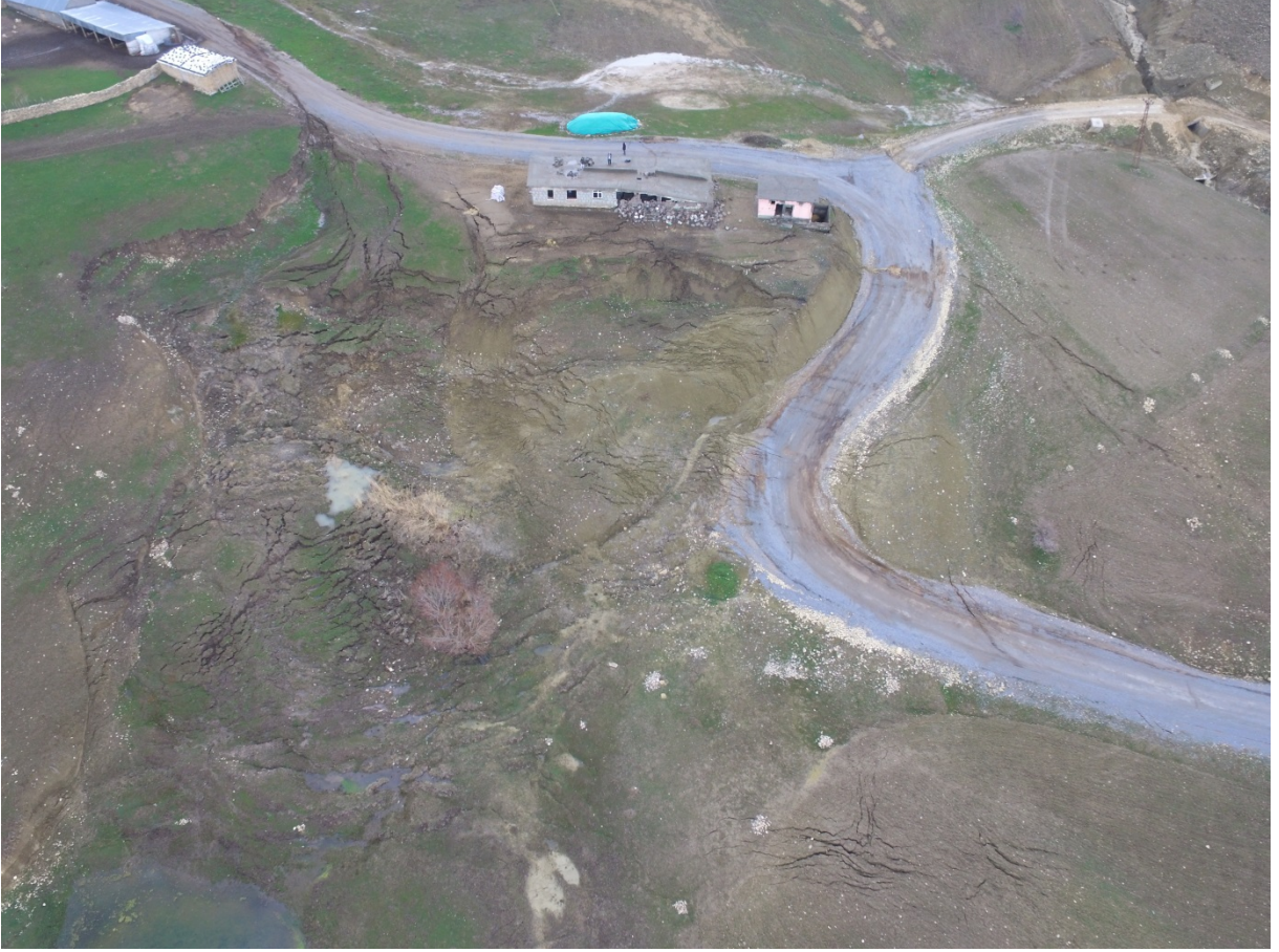
Resim 3: Çağdaş mahallesini etkileyen kompleks heyelan. Kar erimeleri ile yoğun bir kil dolgusuna sahip olan toprak doygun duruma geçerek, yağışlarla birlikte aktivite kazanmıştır.
